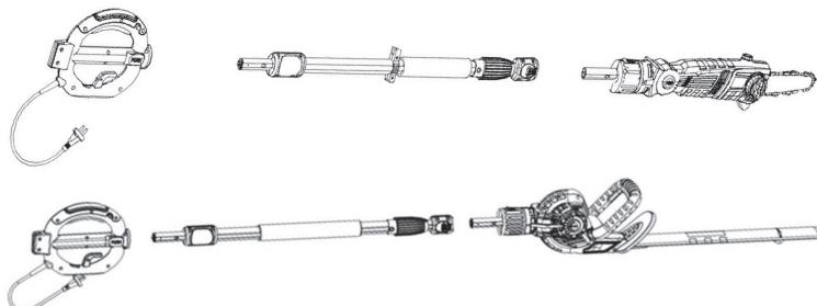
3. Zum Entfernen des Teleskopstiels, drücken Sie erst die Entriegelungstasten PUSH auf beiden Seiten am Handgriff und ziehen Sie den Handgriff heraus.
