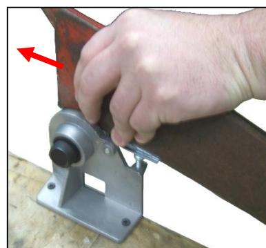
Wenn Sie in der Bedienung der Dengelmaschine geübt sind, können Sie diese Sensenauflage (5) ganz herunterstellen und freihändig dengeln. Die Benutzung der Dengelmaschine erfordert etwas Übung.
