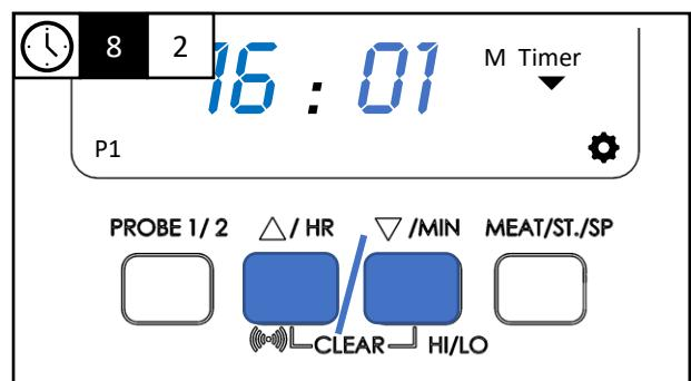
**DE** Zum Einstellen des Timers zunächst den Temperaturfühler auswählen und die Stunde mit der HR-Taste und die Minuten mit der MIN-Taste einstellen.
