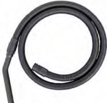
Zubehör: 3 m Antistatikschauch. Art.-Nr. 102.116 Der Schlauch und Stutzen ist elektrisch leitend und sorgt für eine optimale Ableitung von möglicher elektrischer Aufladung über den geerdeten Behälter.
