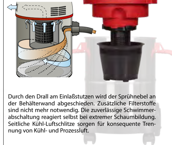
Die Grafik zeigt das patentierte Wasser-Abscheidesystem mit Zykloneinsatz Art.-Nr. 116.105
