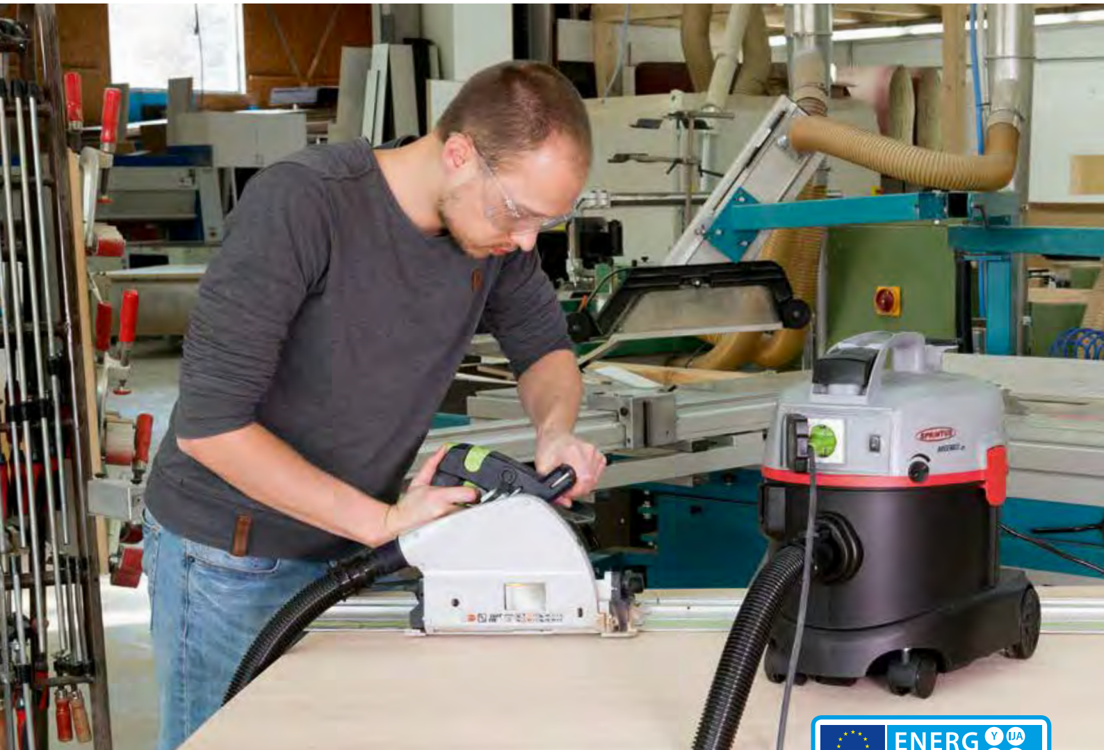
Automatik-Steckdose für den Betrieb von Elektrowerkzeugen.
