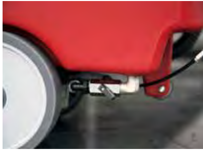
Wassermenge kann individuell auf jeden Bodenbelag eingestellt werden.
