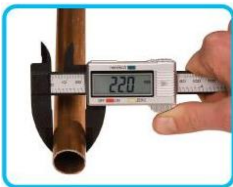
Messungen von Außenmaßen
