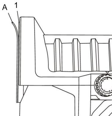
**Achtung:** Das neue Schleifpapier MUSS zentriert und gut angedrückt sein, um Vibrationen und Lösen des Papiers beim Einschalten zu vermeiden. Fliegendes Schleifpapier kann schwere Verletzungen verursachen.
