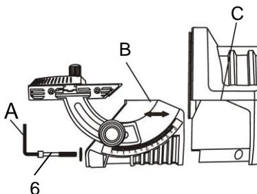
3. Ziehen Sie die komplette Schleiftischbaugruppe (B) nach vorn vom Schleifteller weg. **Hinweis:** Nach dem Abnehmen des Schleiftisches kann das Schleifpapier abgenommen oder angebracht werden, wie unten beschrieben.
