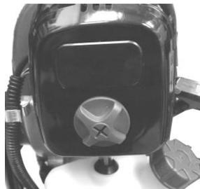
1. Schrauben Sie die Befestigungsschraube ab und nehmen Sie die Luftfilterabdeckung (10) ab. Hinter der Abdeckung befindet sich der Schaumstofffilter.
