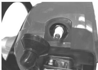
Bei Verwendung eines Drehmomentschlüssels beträgt das Anzugsdrehmoment 12 – 15 Nm.
