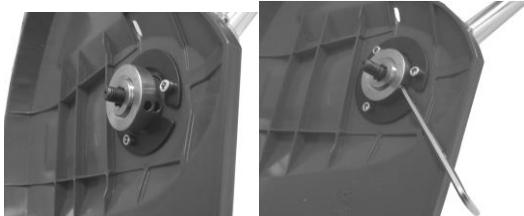
10. Achtung LINKSGEWINDE! Drehen Sie den Trimmfadenkopf auf die Spindel und drehen Sie den Fadenkopf gegen den Uhrzeigersinn fest auf das Gewinde.
